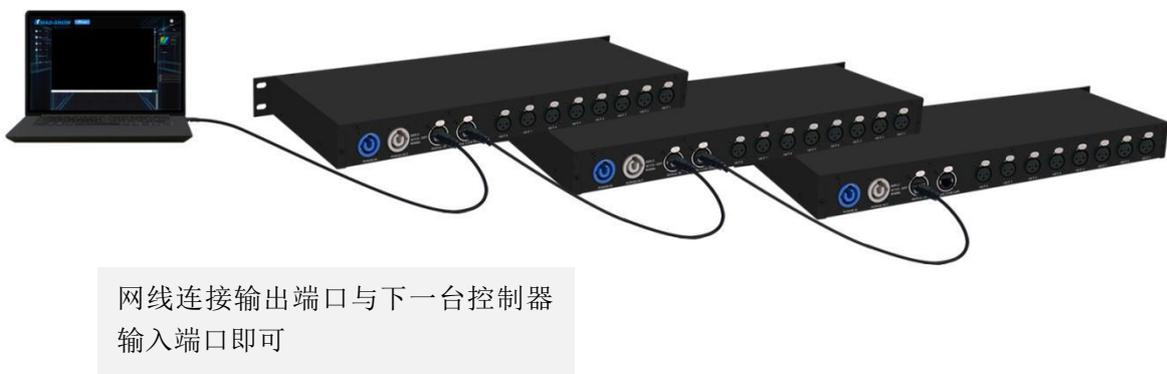
**注意：多台控制器级联时，每台控制器 IP (Controller IP) 设置不可相同！**
